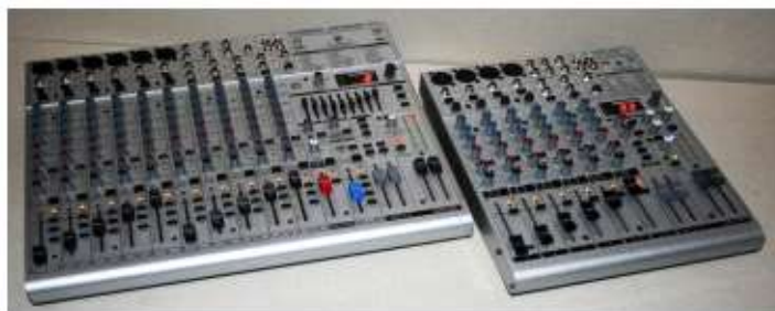
fig.11: Mixer Behringer UB1204FX Pro 8 canale+ Behringer UB1832FX 14 canale
