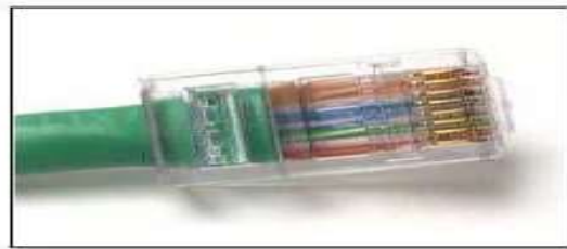
Conectare bună - firele sunt de-răsucite doar pentru porțiunea necesară mufării.
