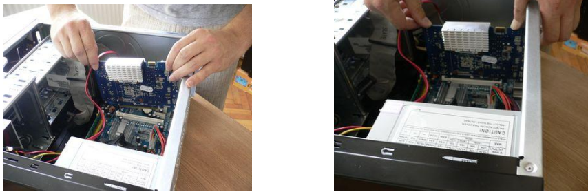
Figura 2.4 Instalare placă grafică
