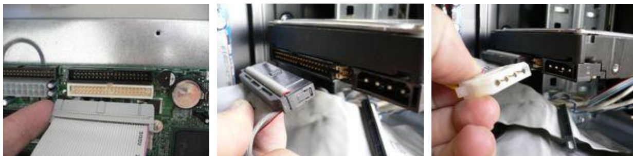
Figura 2.5.4 Conectarea cablurilor interne la un hard disk PATA
