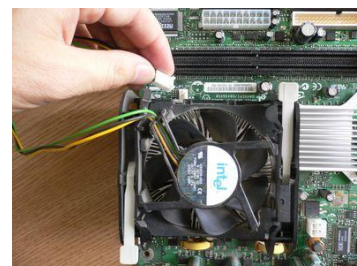
2.2.2 Instalarea de răcire a procesorului
